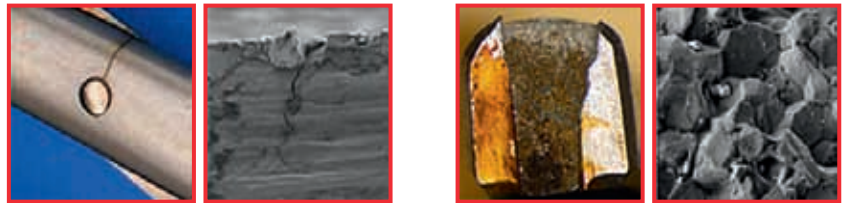
Detail: Schlussgelenk Schere mit typischem interkristallinem Anriss.
