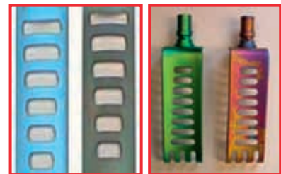
Ausschnitt – Titanvalven: Linke Valve – fabriktneu. Rechte Valve – maschinell gereinigt. Meist erfolgt die Farbänderung gleichmäßig. Sie kann allerdings auch fleckig/mehrfarbig ausfallen.
