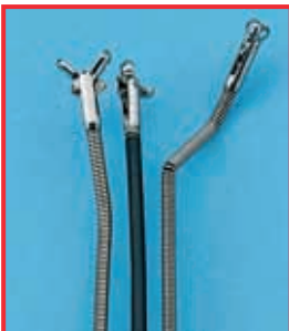
Gewaltsam beschädigte Biopsiezangen
