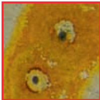
Chloridhaltiges Regeneriersalz führte zu massivem Lochkorrosionsbefall auf der Instrumentenoberfläche. Ursache: undichter Anschluss des Ionentauschers im RDG.
