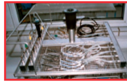
geeigneter Injektorwagen zur Reinigung und Spülung ophthalmologische Instrumente
