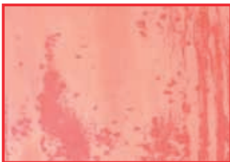
Optische Veränderung bei farbeloxiertem Aluminium schon bei milder Alkalität
