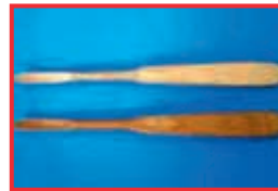
Führungs-Hohlsonde; Oberfläche neuwertig: glänzend mittelbraun ausgeblichen: matt-weiß gebleicht
