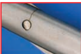
Haarriss im Gewindebereich einer Schere
