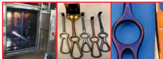
Typische Silikatverfärbungen in der Spülkammer und auf der Instrumentenoberfläche durch silikathaltige Reiniger oder zu hohen Kieselsäuregehalt im Wasser
