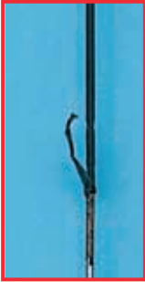
Beschädigte Isolierung an einem HF-Instrument
