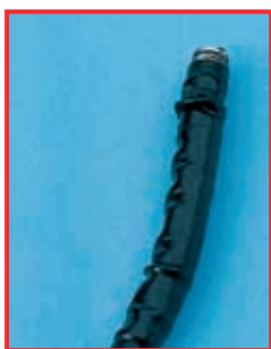
Aufquellung am Distalende eines Fiberskops
