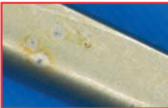
Chloridinduzierte Lochkorrosion auf dem Instrument
